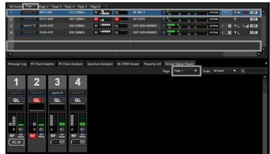
La posición del canal receptor 1 cambia a la posición en la que se haya soltado. La posición del canal receptor 1 también cambia en el visor de estado simple, vinculado al movimiento en el visor de estado.
