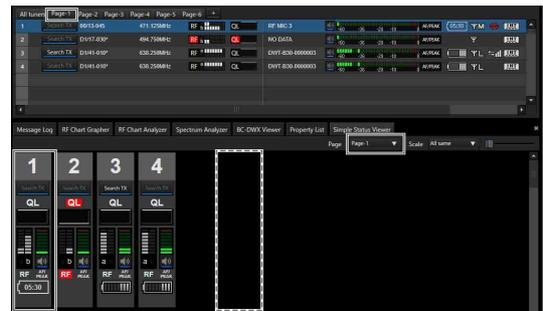
**Ejemplo 3: Cambio de posición de los canales receptores con el ajuste [Diversity] de 4-ANTENNA a un área de canal vacía**
