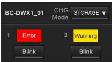
**Error:** se ha detectado un error de sobretensión o carga
