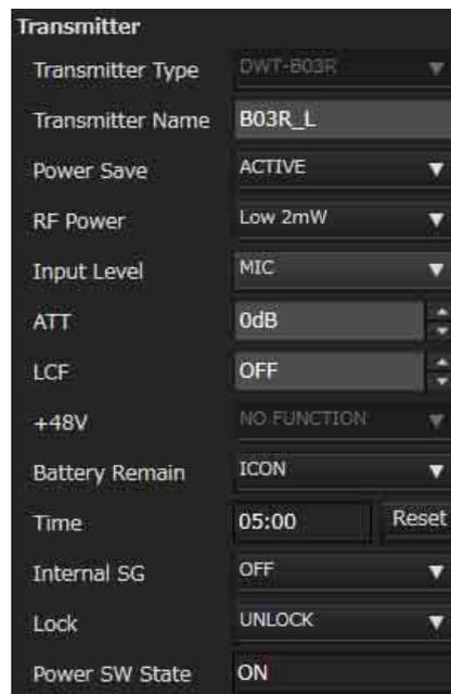
**Transmitter Type:** en el modo en línea, este ajuste no se puede modificar. Especifique el modelo del transmisor sincronizado con el receptor en el modo fuera de línea.
