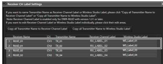
Si se abre la ventana [Receiver CH Label Settings] cuando el ajuste [Diversity] de los canales 1 y 2 del receptor es 4-ANTENNA, se mostrará solo el canal 1.
