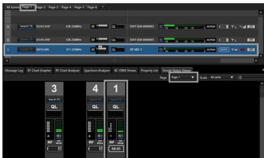
En la versión 5.50 y posteriores del visor de estado simple, puede cambiar la posición de los canales receptores registrados según sus preferencias en páginas distintas a [All tuners] (moviéndolos a la posición de la línea de puntos del siguiente ejemplo).
